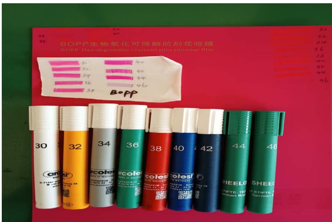
图三经过达因笔测试 BOPP 薄膜达因值 44mN/m
