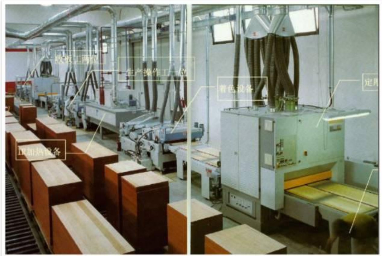
木地板底漆生产线
